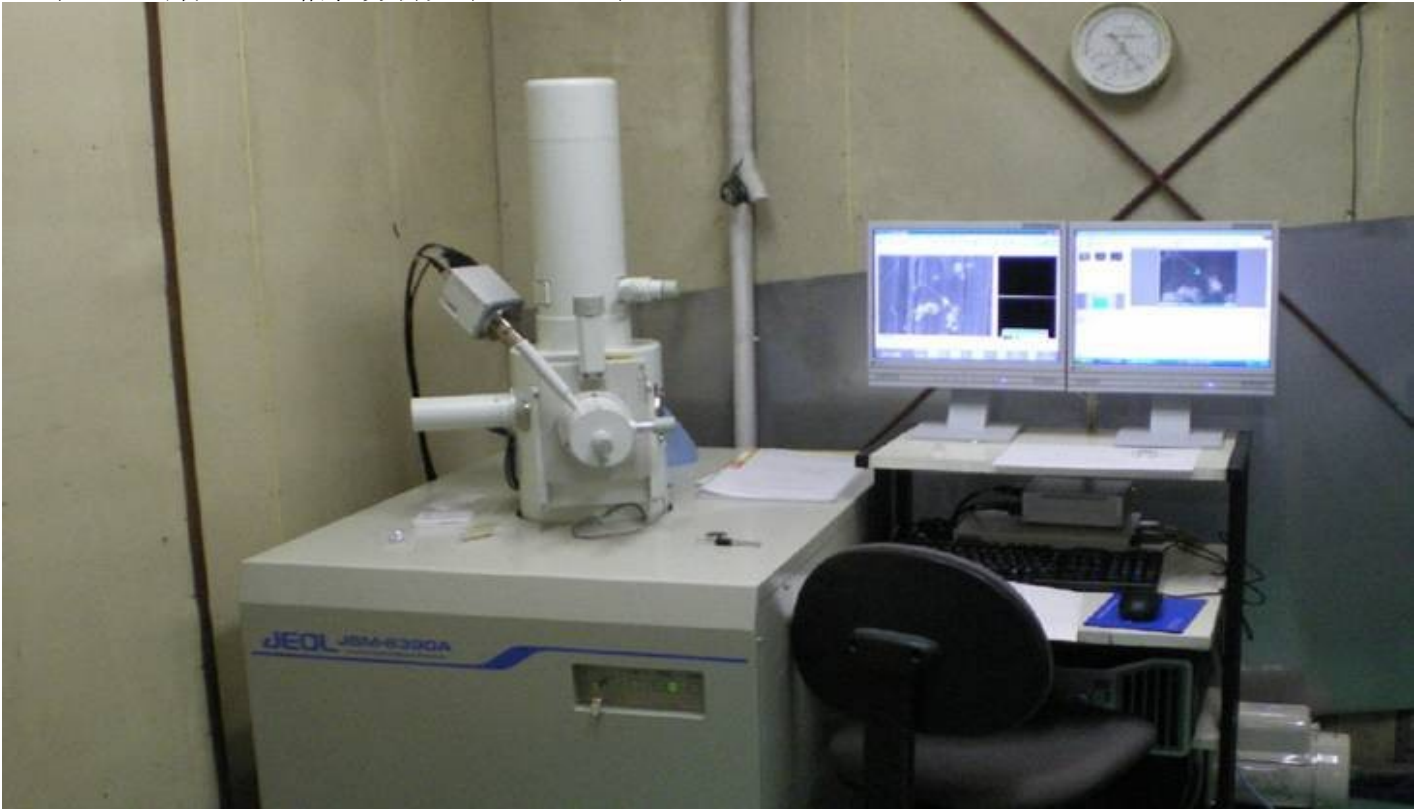
材料の観察・組成分析等に威力を発揮するSEM/EDS (JSM-6390、Dry-EDX付き)
